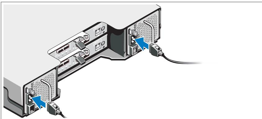
在连接电源电缆之前，请确保电源开关处于 OFF（关闭）位置。将系统的电源电缆连接到系统上。
